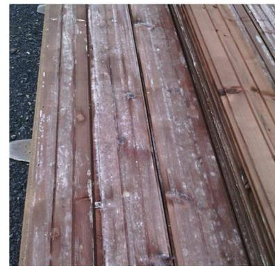
Il ritorno rapido al 20% d'umidità, corrispondente al DTU, normativa francese, per la pose del legno piallato in autoclave, evita l'apparizione della muffa bianca sul legno e il riscaldamento.
